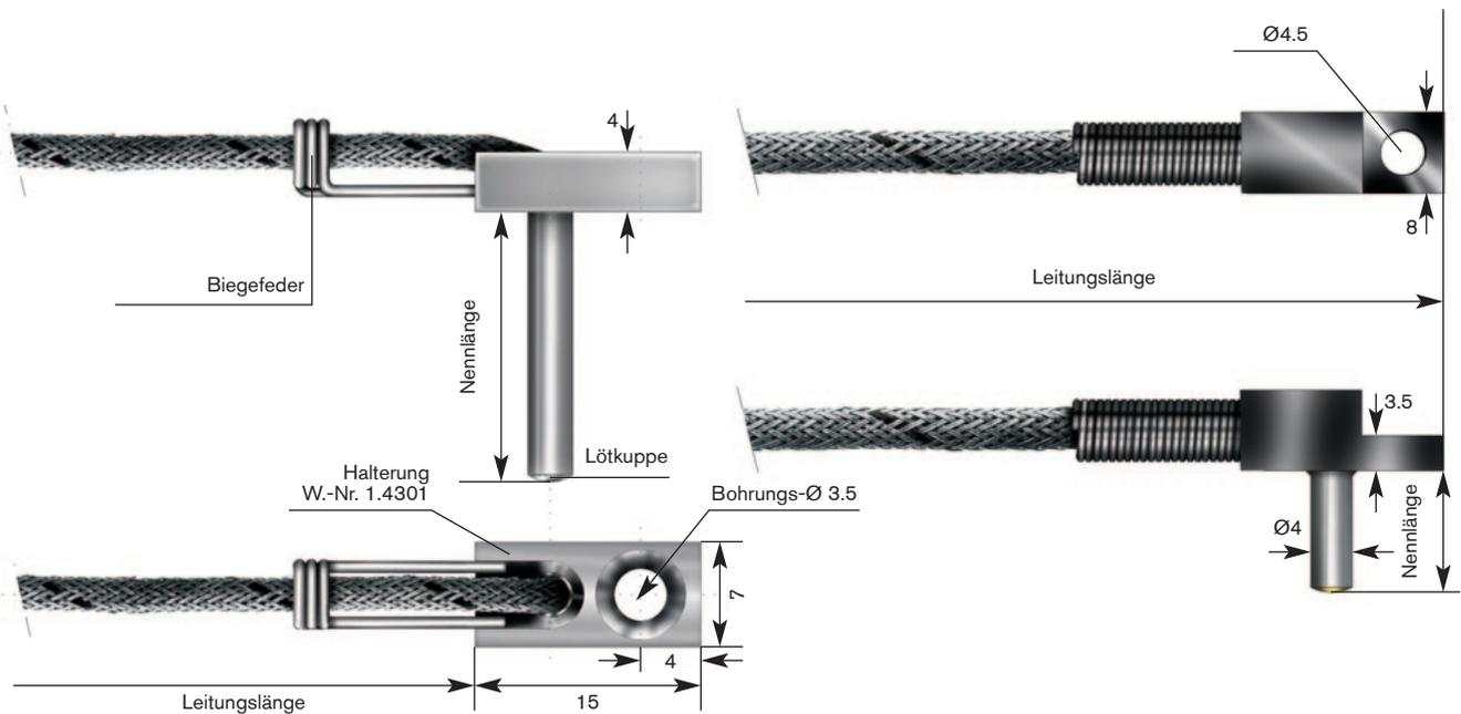
■ Winkel-Thermoelemente werden für die Temperaturerfassung an Werkzeugen eingesetzt. Einfach mit einer Schraube mit Vorspannung (gewährleistet den Kontakt zwischen Fühler und der zu messenden Fläche) anzubringen. Das VA-Stahldrahtgeflecht der Anschlussleitung dient als mechanischer Schutz.
