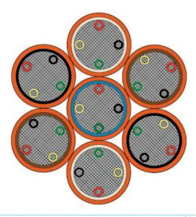
Aplicación: Construcción simétrica con gran flexibilidad. Pequeño radio de curvatura (permite un fácil enrollado incluso en espacios reducidos) y alto rendimiento eléctrico (baja caída de tensión y bajo desequilibrio de tensión). Se puede utilizar en longitudes de inserción más largas.
