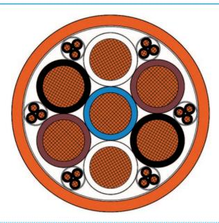
Aplicación: Para uso como cable de alimentación de tendido permanente con una capacidad de instalación especialmente buena o para uso flexible sin grandes esfuerzos mecánicos en aplicaciones portátiles, por ejemplo, GPU móviles. Flexibilidad optimizada gracias a los materiales flexibles del núcleo y de la cubierta exterior, por lo que ofrece una excelente capacidad de tendido y un manejo sencillo.
